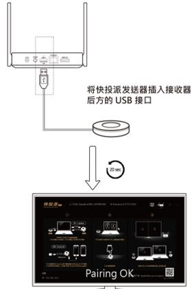
外接屏幕显示“Pairing OK”代表配对成功即可拔除USB线
